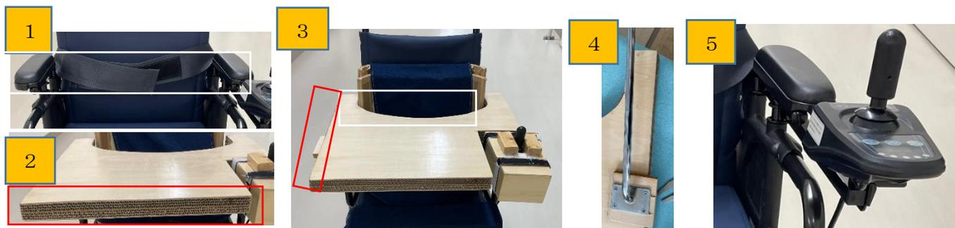
・写真1の肘台の上に、写真3のようにテーブルを乗せます。テーブルを安定させるためには、テーブルの固定用バー（写真4）を取り付けます。写真4のバーの差し込み口は、写真の5のコントロールボックスと反対側の差し込み口を利用します。固定用バーは、写真3の赤枠の下方に取り付けてあります。テーブルは、写真2の赤枠のように、シナベニアの間にトライウォールを重ねて作成します。厚みは4センチです。この厚みのテーブルを使用するのは、設定されている肘台の高さが低すぎるため、基準となる肘台の高さを4センチ高くした方が、様々な児童・生徒が使用する際に適合しやすいと考えたためです。
