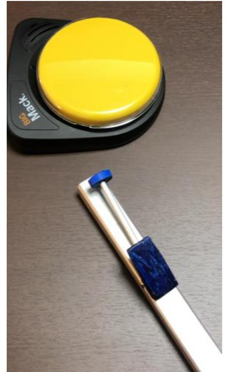
(2) 溝を掘り、穴をあけて、マイクロスイッチを埋め込む。
